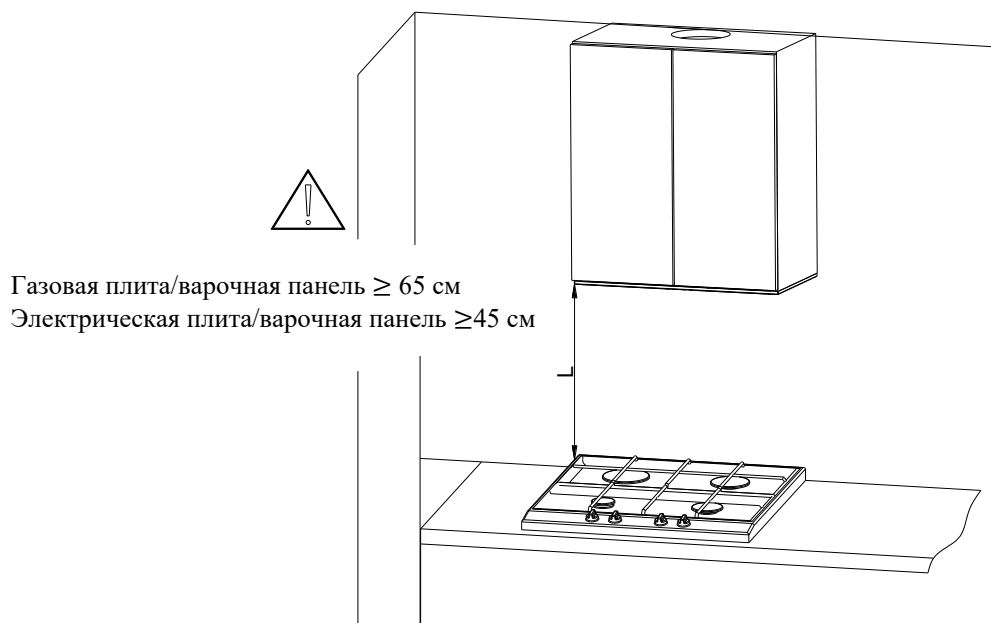
Рис. 3 Рекомендуемое расстояние для установки
